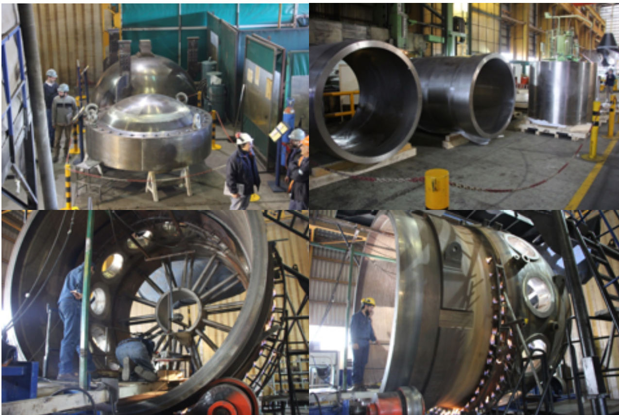
Ilustración 3. Recipiente de Presión del Reactor CAREM25 – Construcción IMPSA Argentina.
